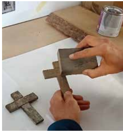
Die bestehenden Holzkreuze werden abmontiert, dann in der Werkstatt sorgfältig abgeschliffen, anschliessend frisch bemalt und zu guter Letzt neu montiert.
